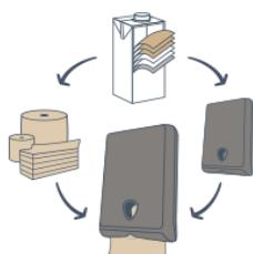
Grâce à un **procédé exclusif** et mécanique, Lucart parvient à séparer les matériaux des briques alimentaires afin de les recycler totalement. Les fibres de cellulose, dont la qualité est similaire à de la pure ouate, deviennent le **Fiberpack®**, dont sont faits les produits d'essuyage EcoNatural. L'aluminium et le polyéthylène deviennent l'**AI.Pe.®**, utilisé pour fabriquer les appareils EcoNatural Flow.
