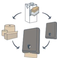
Grâce à un **procédé exclusif** et mécanique, Lucart parvient à séparer les matériaux des briques alimentaires afin de les recycler totalement. Les fibres de cellulose, dont la qualité est similaire à de la pure ouate, deviennent le **Fiberpack®**, dont sont faits les produits d'essuyage EcoNatural. L'aluminium et le polyéthylène deviennent l'**Al.Pe.®**, utilisé notamment pour fabriquer les appareils EcoNatural Flow.
